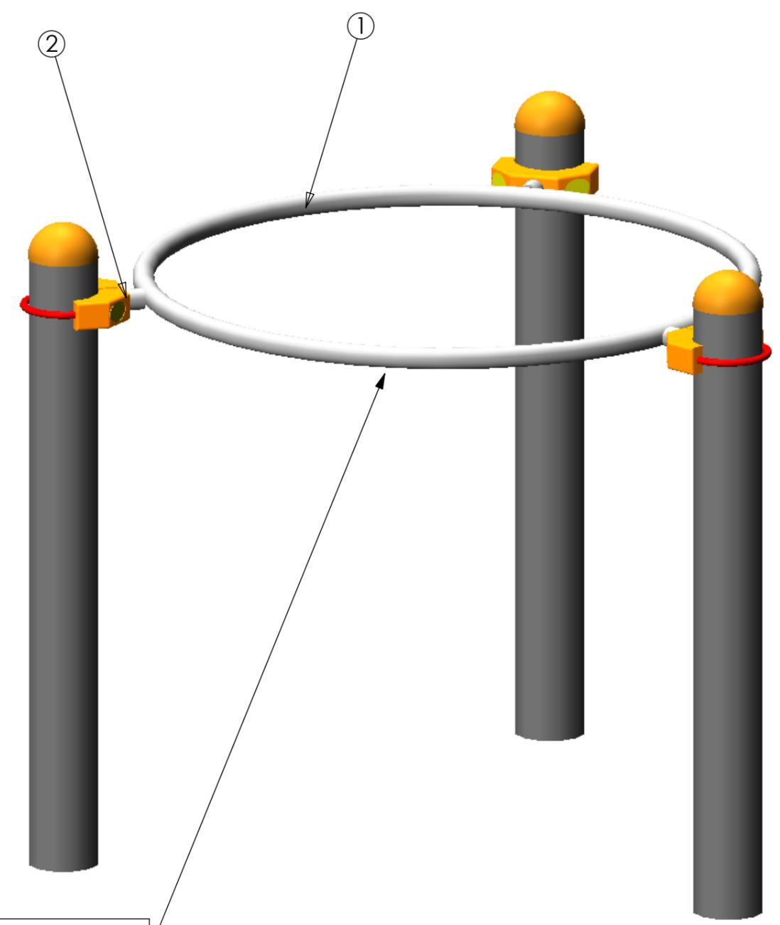
Fixation à une hauteur comprise entre 650 et 800 mm par rapport au plancher
