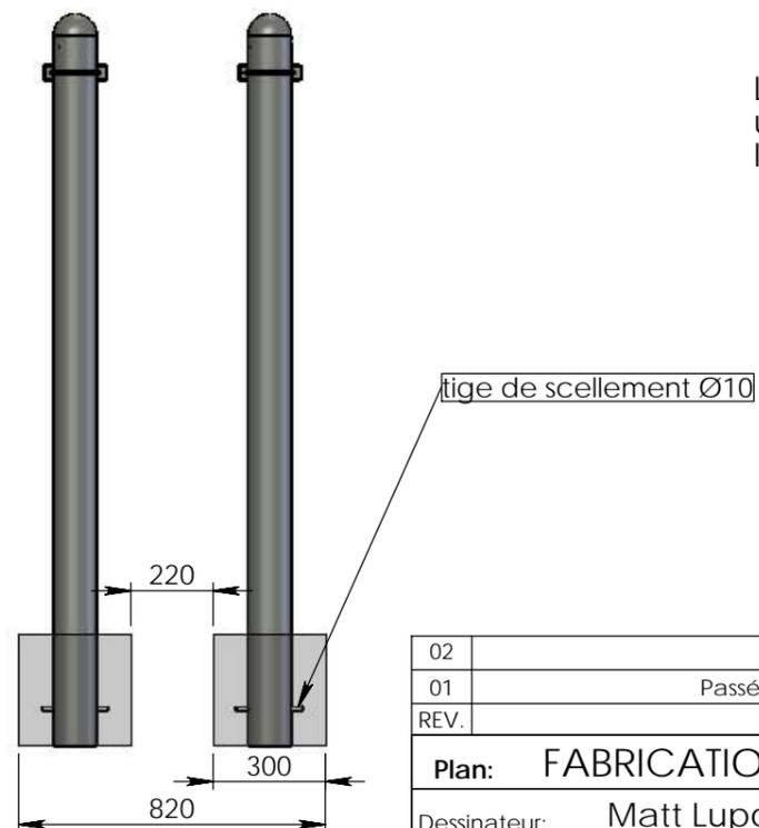
Les plots peuvent être remplacés par une longrine de 920x400mm profondeur 400mm
