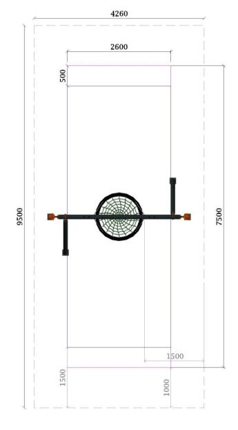
zone d'impact pour sol fluent : 19,5 m² zone d'impact pour sol synthétique : 16,9 m² zone d'implantation pour une clôture
