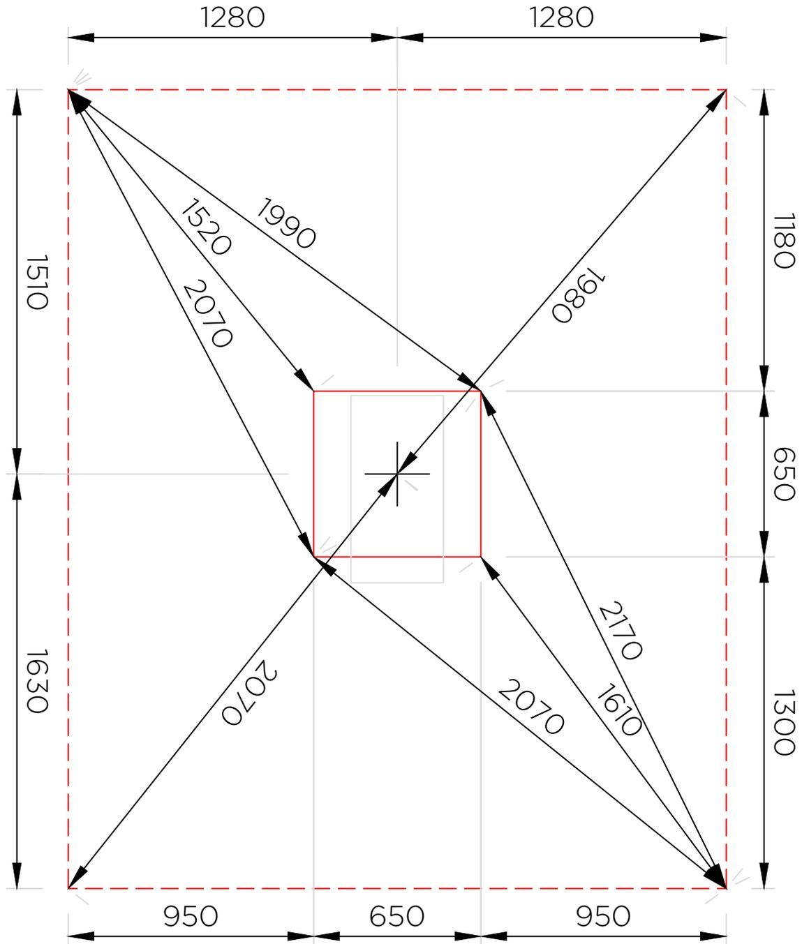
**Scellements:** 0,13 m<sup>3</sup> de béton
