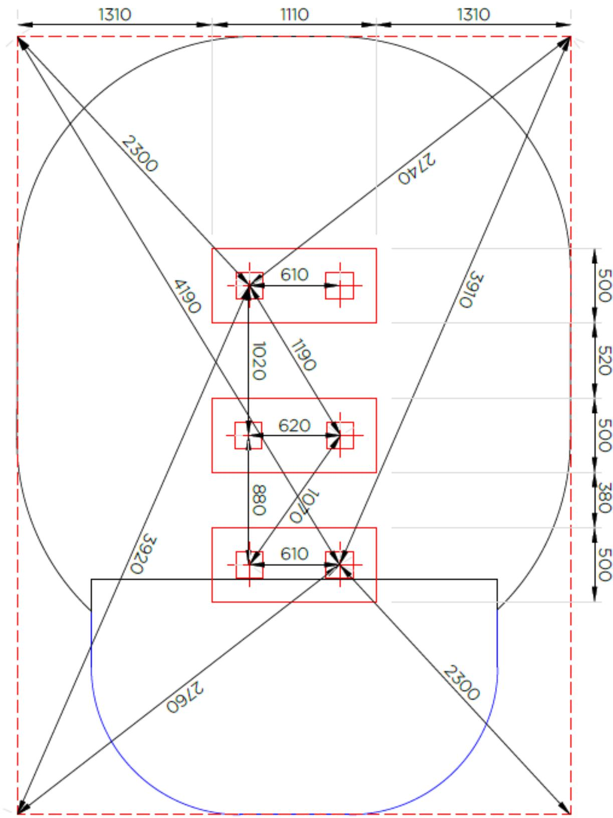
**Scellements:** 0.5 m<sup>3</sup> de béton
